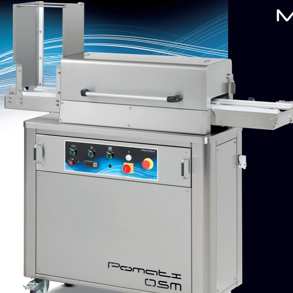
OSM Pomati è progettato per carico e pre-riscaldamento automatico di stampi in policarbonato (175x275). Una torre di caricamento stampi alimenta il nastro per la fase di pre-riscaldamento effettuata da quattro lampade a infrarosso all'interno di una copertura. Possibilità di carico manuale o automatizzato collegato a macchine preesistenti. Velocità e temperatura di riscaldamento gestibili da un semplice pannello di comando.
